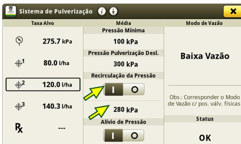
Ajuste a pressão de recirculação para o máximo de 551 kPa em função dos produtos utilizados para obter maior ou menor agitação. É válido ressaltar que a pressão da bomba de solução pode ser afetada quando recirculação está habilitada, isso ocorre devido a recirculação também demandar fluxo da bomba de solução para seu funcionamento.
