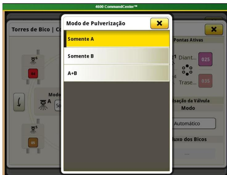
O modo de pulsação A+B utiliza duas pontas (A e B), com os solenoides pulsando simultaneamente a 15Hz, defasados entre si. Esse modo é vantajoso porque proporciona compensação de curva e seleção de pressão alvo.
