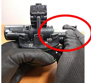
A desmontagem da válvula deve ser feita utilizando o suporte (4), taquímetro calibrado (1) e gancho (6) presentes no kit de manutenção.
