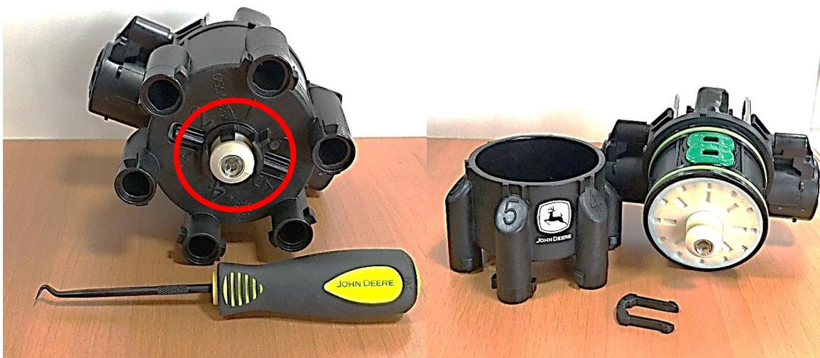
Inicie a desmontagem da bobina retirando o pino "R" que faz a junção e travamento do conjunto bobina e solenoide. Pressione o dedo polegar no corpo da torre e com ajuda do dedo indicador puxe o pino.
