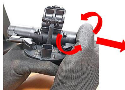
**IMPORTANTE:** Exercer movimentos bruscos e/ou de "alavanca" durante a retirada da bobina pode danificar a válvula internamente.
