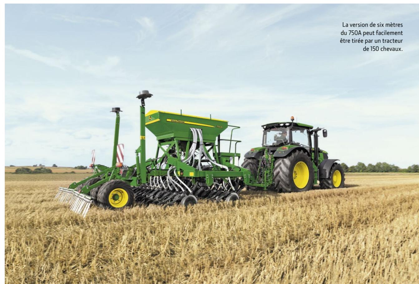
La version de six mètres du 750A peut facilement être tirée par un tracteur de 150 chevaux.
