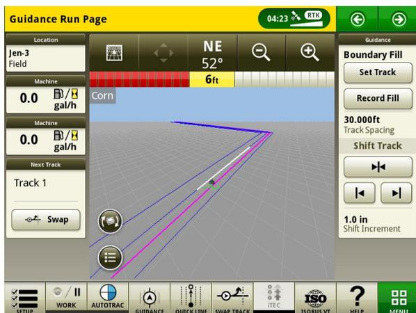
Füllen der geraden Spur ab der Feldgrenze – Eine gerade Spur A+B kann mühelos erstellt werden, wenn AutoTrac™ mit Feldgrenzenfüllmuster verwendet wird. Wenn an einer Spur für Feldgrenzenfüllung 'Füllung aufnehmen' verwendet wird, werden gerade Spuren A+B erstellt, um den Bereich innerhalb der Vermessung und der anhand der Vermessung erstellten Spuren zu füllen. Nachdem Spuren erstellt wurden, müssen sie aus der Spurenliste ausgewählt werden.
