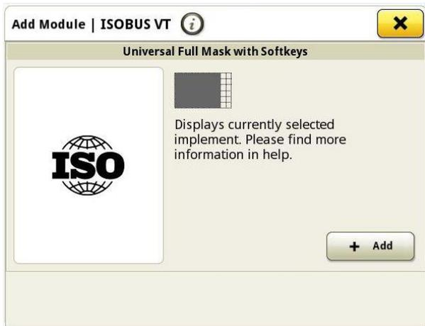
Palanca de control ISOBUS — AUX-N: Un asistente de asignación para palancas de control ISOBUS AUX-N se encuentra disponible con la actualización de software 18-2. Permite asignar las funciones de apero ISOBUS de manera más rápida e intuitiva a las palancas de control AUX-N. El asistente reduce la cantidad de acciones que se necesita hacer para hacer una asignación, de cuatro clics a un solo clic.
