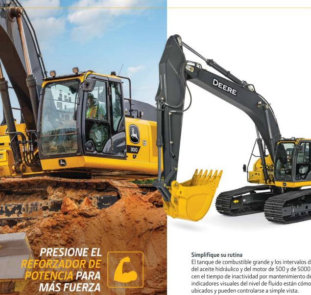
El tanque de combustible grande y los intervalos de servicio del aceite hidráulico y del motor de 500 y de 5000 horas reducen el tiempo de inactividad por mantenimiento de rutina. Los indicadores visuales del nivel de fluido están cómodamente
