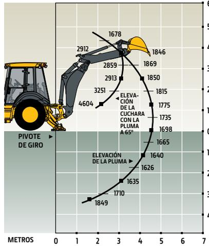
**MODO DE LEVANTAMIENTO con Brazo Extendible de 1,06 m, Extendido**
