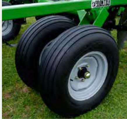
Optional dual wheels provide higher flotation on the DH1510 and DH1512 models. Single wheels are standard.
